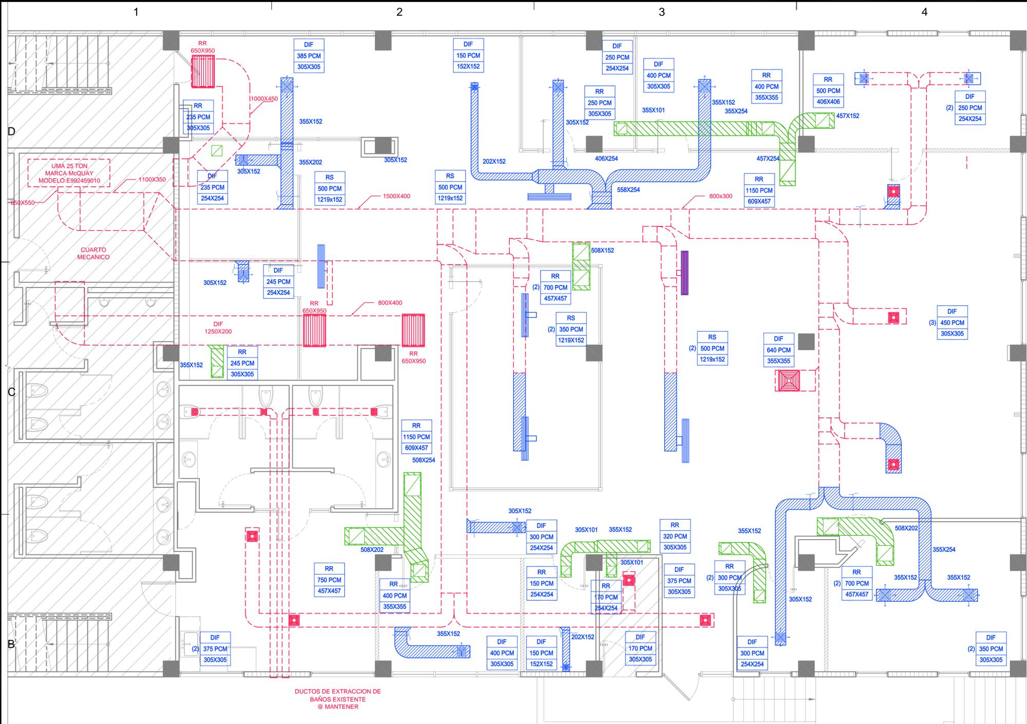
**PLANTA DE DUCTOS DE AIRE ACONDICIONADO NUEVO**
