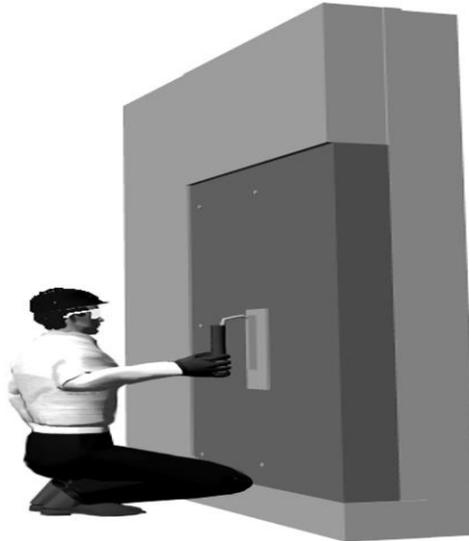
*Imagen 77. Aplicación de mortero de reparación superficial.*
