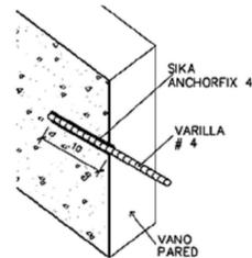
DETALLE DE ANCLAJE PARA PUERTAS Y VENTANAS DE HERRERÍA
