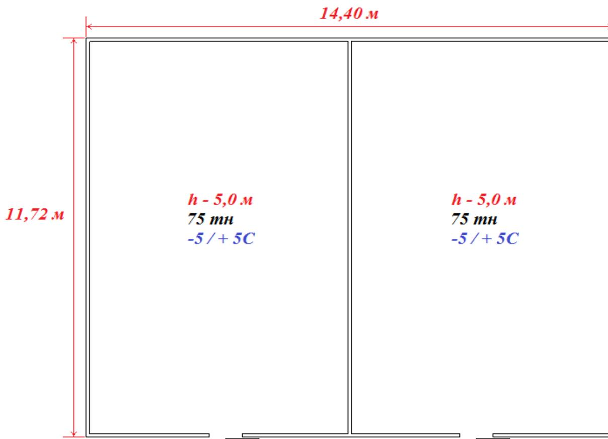
Рисунок 2. Фасадный вид холодильной камеры:
