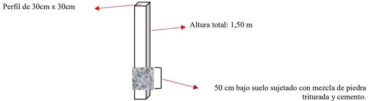
**Observación:** material a utilizar metal. Se deberá contar con 6 unidades de bases por cada portabandejas, conforme el Gráfico 2 de Anexos.
