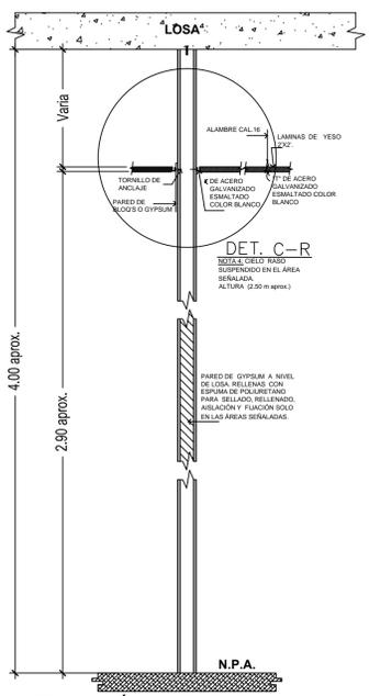
DET. UNIÓN DE GYPSUM A CIELO RASO Y LOSA
