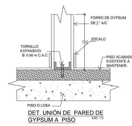
DET. UNIÓN DE PARED DE GYPSUM A PISO
