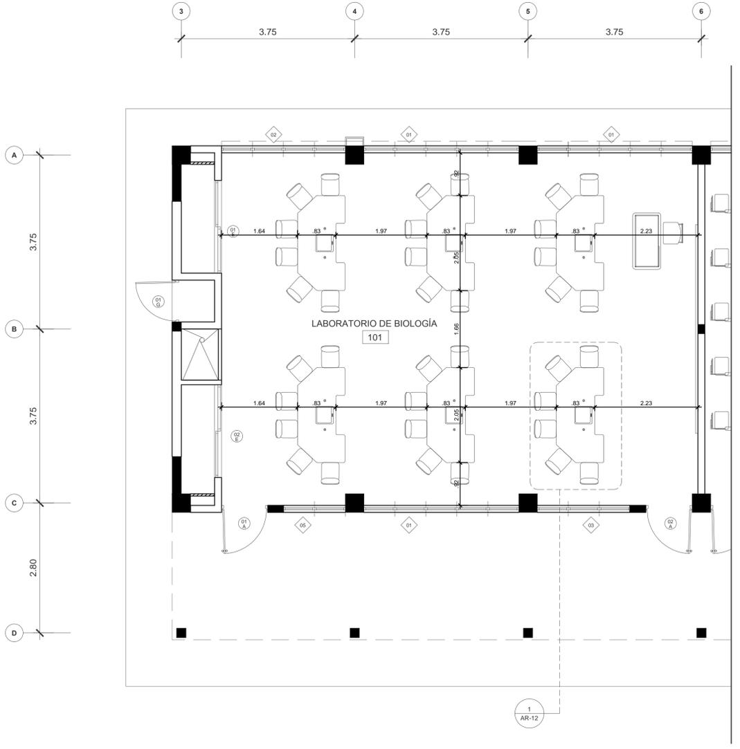
1 DETALLE DIMENSIONADO DEL LABORATORIO EDIFICIO DE AULAS Y LABORATORIOS
