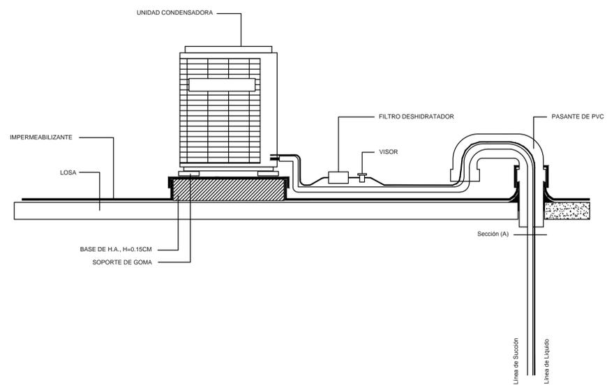
3 DETALLE DE FAN COLL Y UNIDAD CONDENSADORA
