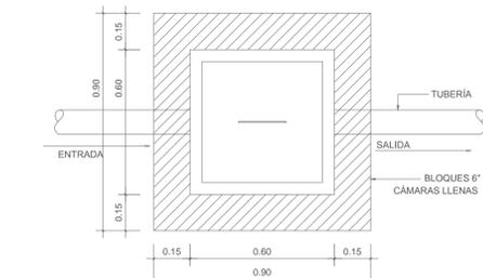
8 SECCIÓN POZO FILTRANTE
