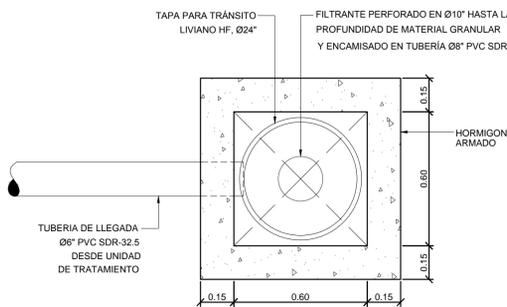
6 SECCIÓN POZO FILTRANTE
