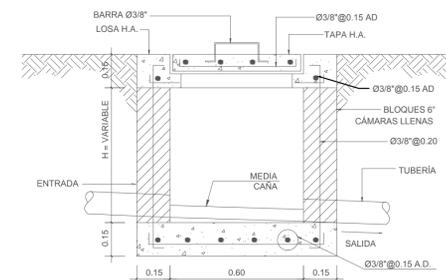
11 SECCIÓN CÁMARA DE INSPECCIÓN
