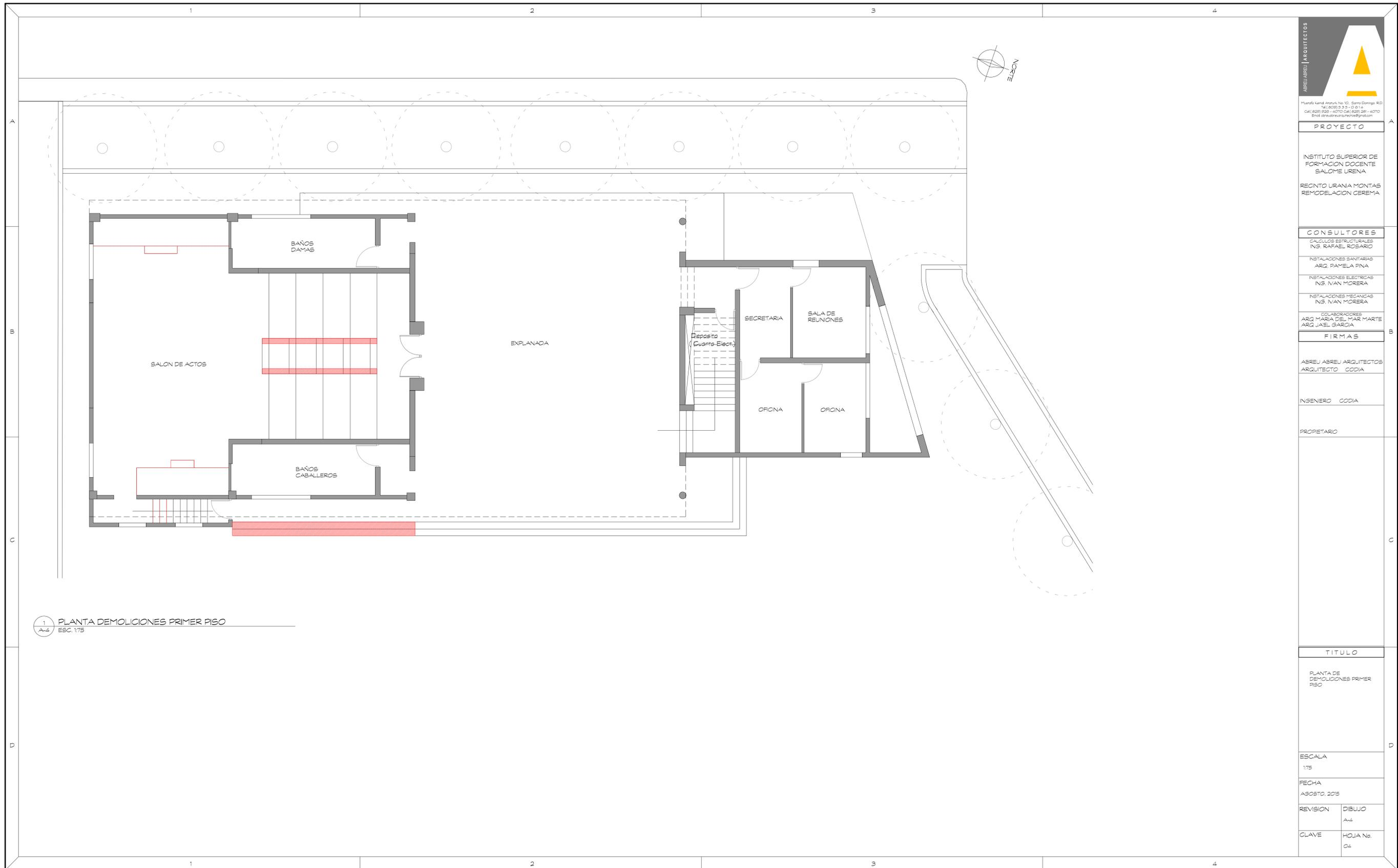
1 PLANTA DEMOLICIONES PRIMER PISO
