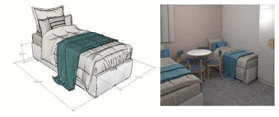
**Dimensions :** 1900 mm  $\times$  900 mm  $\times$  850 mm
