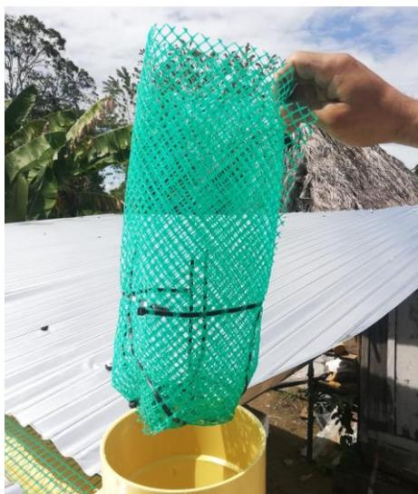
Figura No.23 Canastilla para filtro elaborada con cedazo sintético
