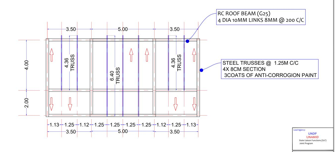
**ROOF BEAMS & TRUSS LAYOUT**
