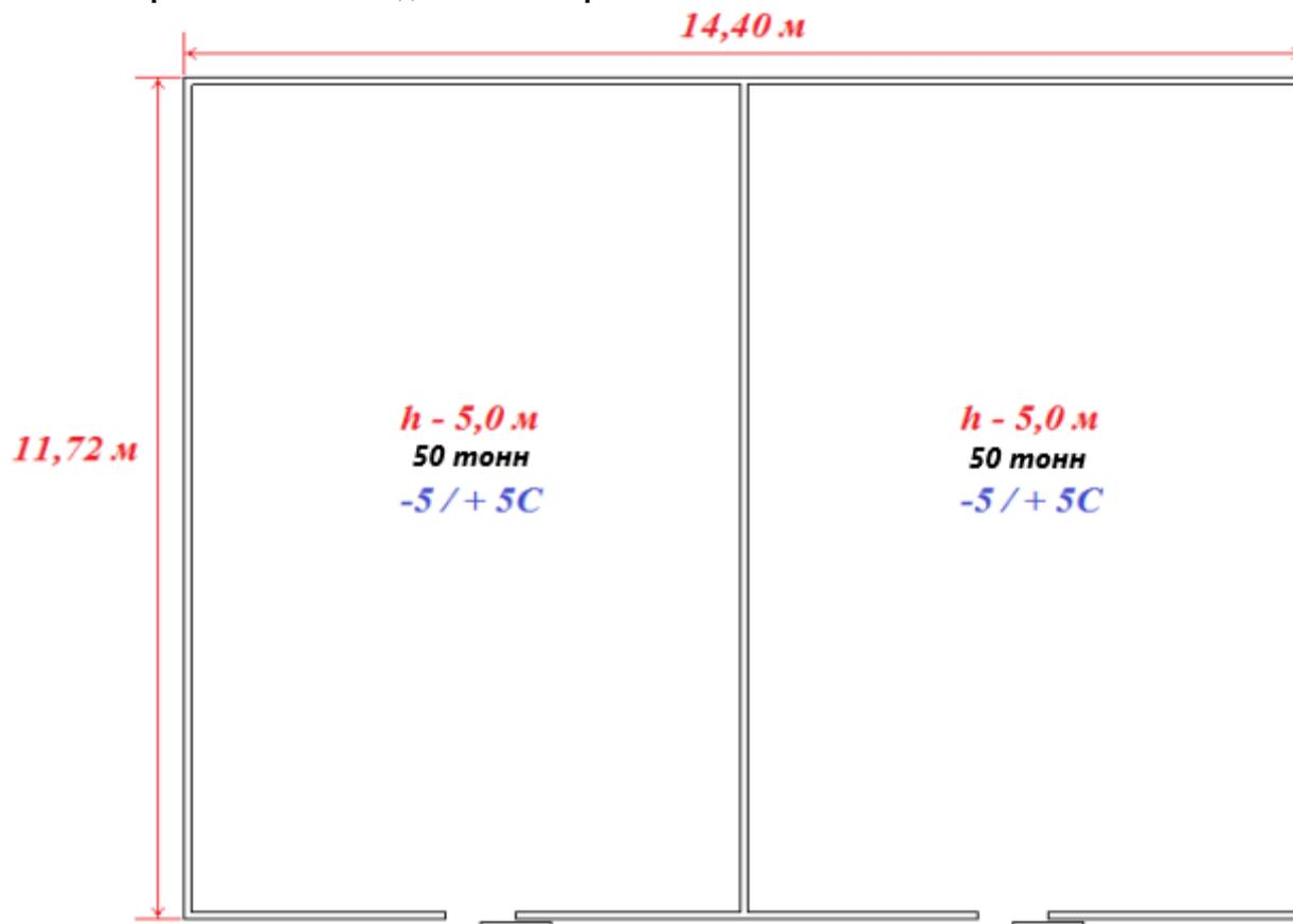
Рисунок 2. Фасадный вид холодильной камеры:
