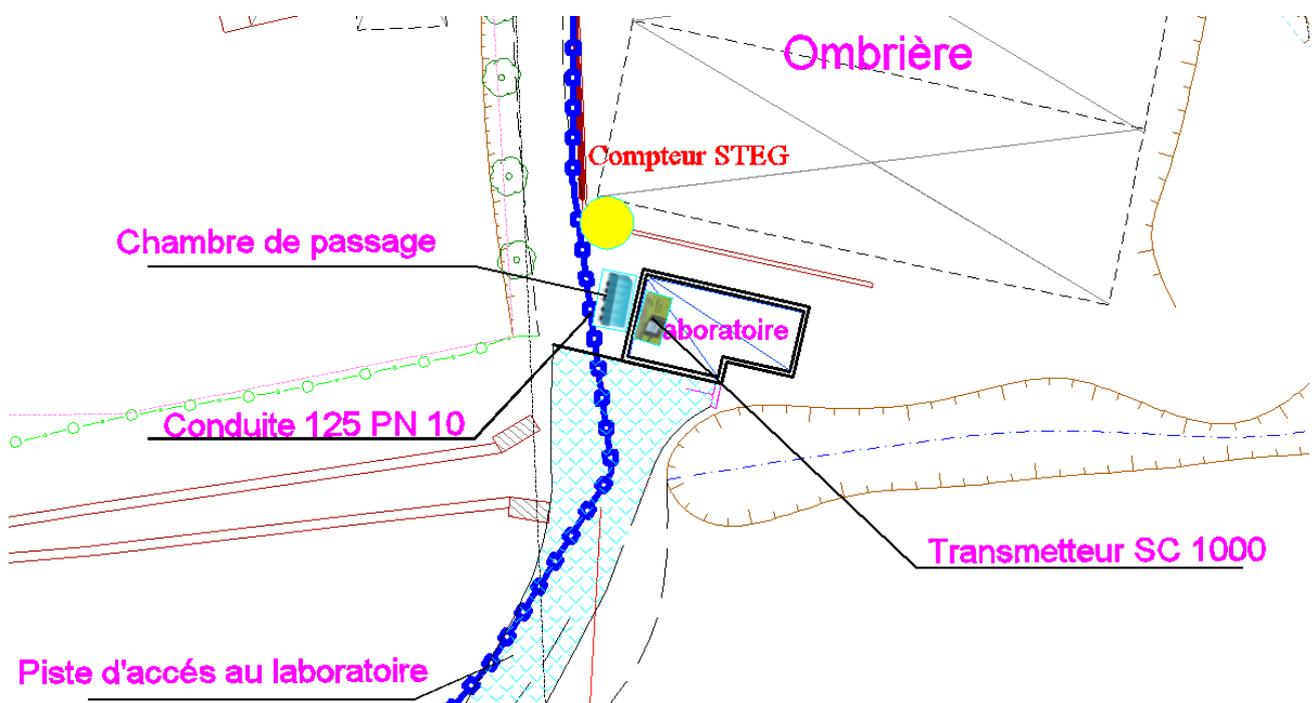
Un piquage en DN 32 sera effectué dans le sens de l'écoulement sur le bas de la conduite DN 125 ; il devra permettre le prélèvement d'une fraction en continu chaque fois que les eaux s'écoulent dans la conduite d'alimentation du périmètre irrigué. La pression de service sera de l'ordre de 4 bars, une crépine 2" devra jouer le rôle de brise charge à l'entrée de la chambre de passage où seront installées les différentes sondes.
