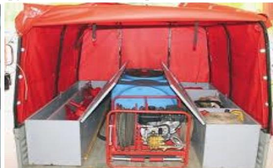
Малый лесопожарный модуль на базе автомобиля УАЗ-39094
