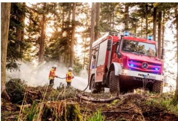
Этот Unimog модели U5023 был построен по спецзаказу волонтерской пожарной команды, работающей в северной части знаменитого немецкого лесного массива Шварцвальд. Пожарный внедорожник оснащен 231-сильным двигателем, крутящий момент которого достигает 900 Нм. Дорожный просвет 45 см и полный привод позволяют машине полной массой 14,5 тонны преодолевать любые препятствия на пути к зоне пожара.
