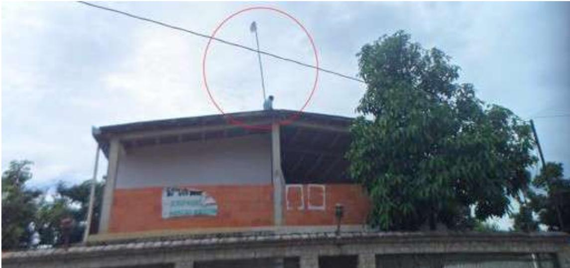
Se debe realizar instalación de un mástil tipo pedestal de 5 mts de altura con vientos. En la imagen se puede observar lo ubicación recomendada en la platabanda de la casa. Se debe considerar la instalación en el mismo mástil de una antena y un AP wifi que dará cobertura hacia el colegio ubicado en frente de la casa.
