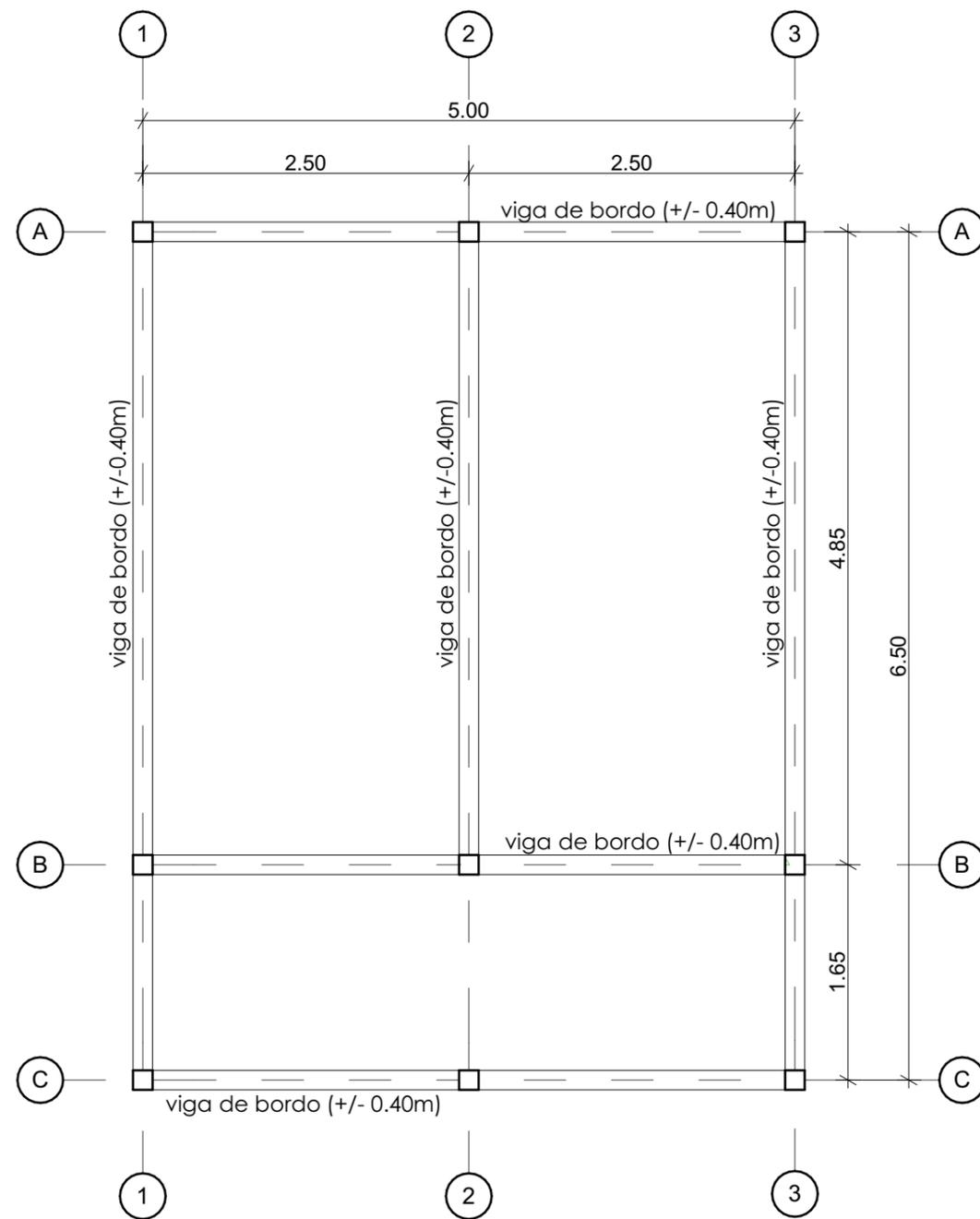
Planta de viga de pavimento/bordo
