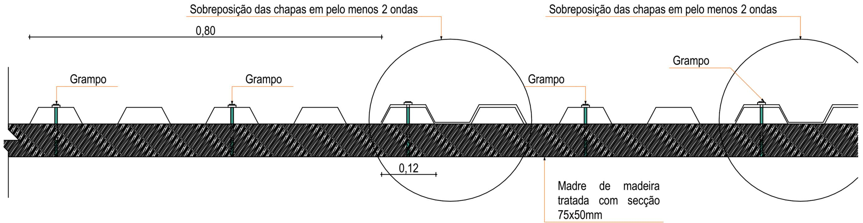
PORMENORES DE FIXAÇÃO DE CHAPAS IBR COM GRAMPOS CHAPAS DE FIXAÇÃO
