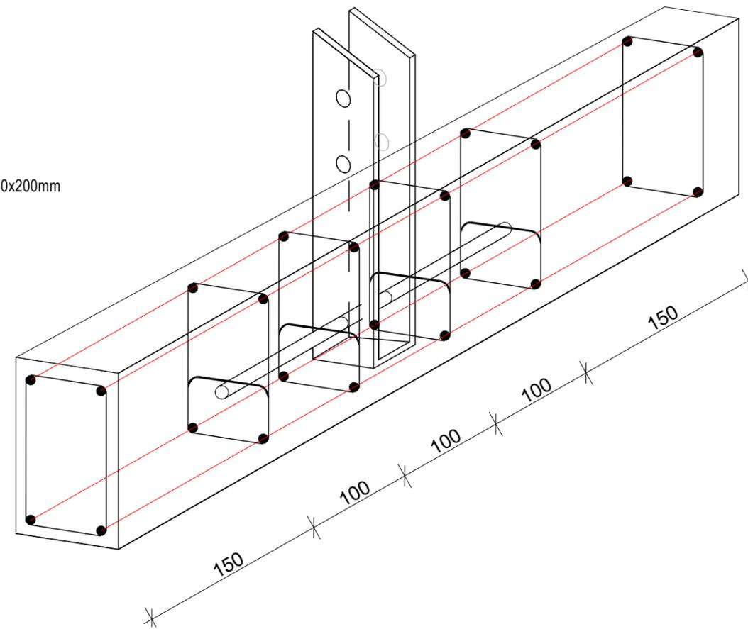
Pormenor de Fixação da Chapa metálica na viga
