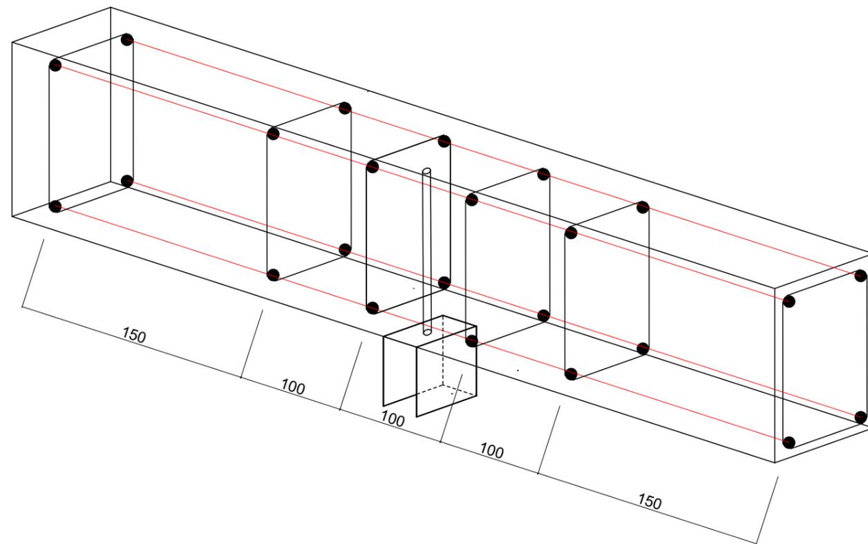
Pormenor de Fixacao da Chapa metalica na viga para cobertura da varanda
