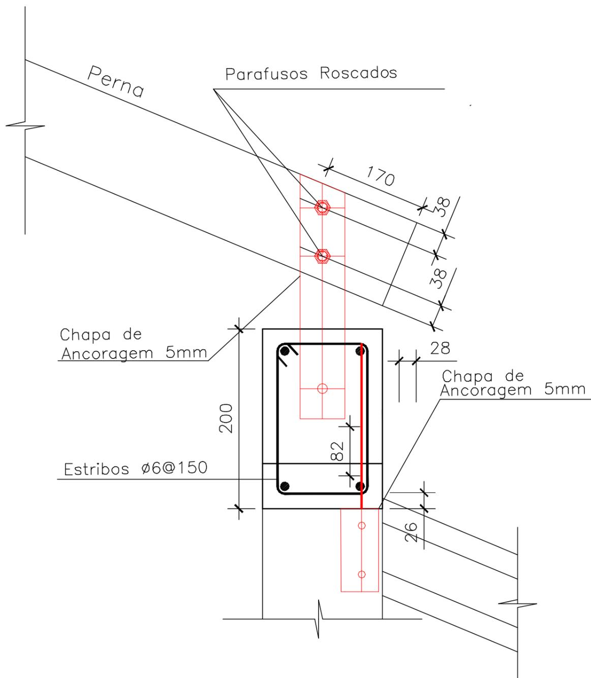
Detalhe 01- Fixacao da Chapa metalica na viga e pilar
