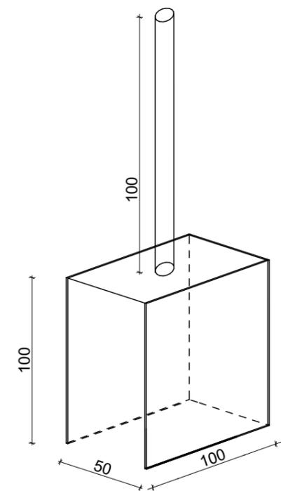
Chapa de Ancoragem para Viga (ancoragem das pernas da varanda)
