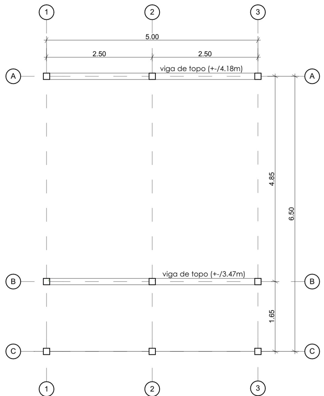
Planta de viga de Topo
