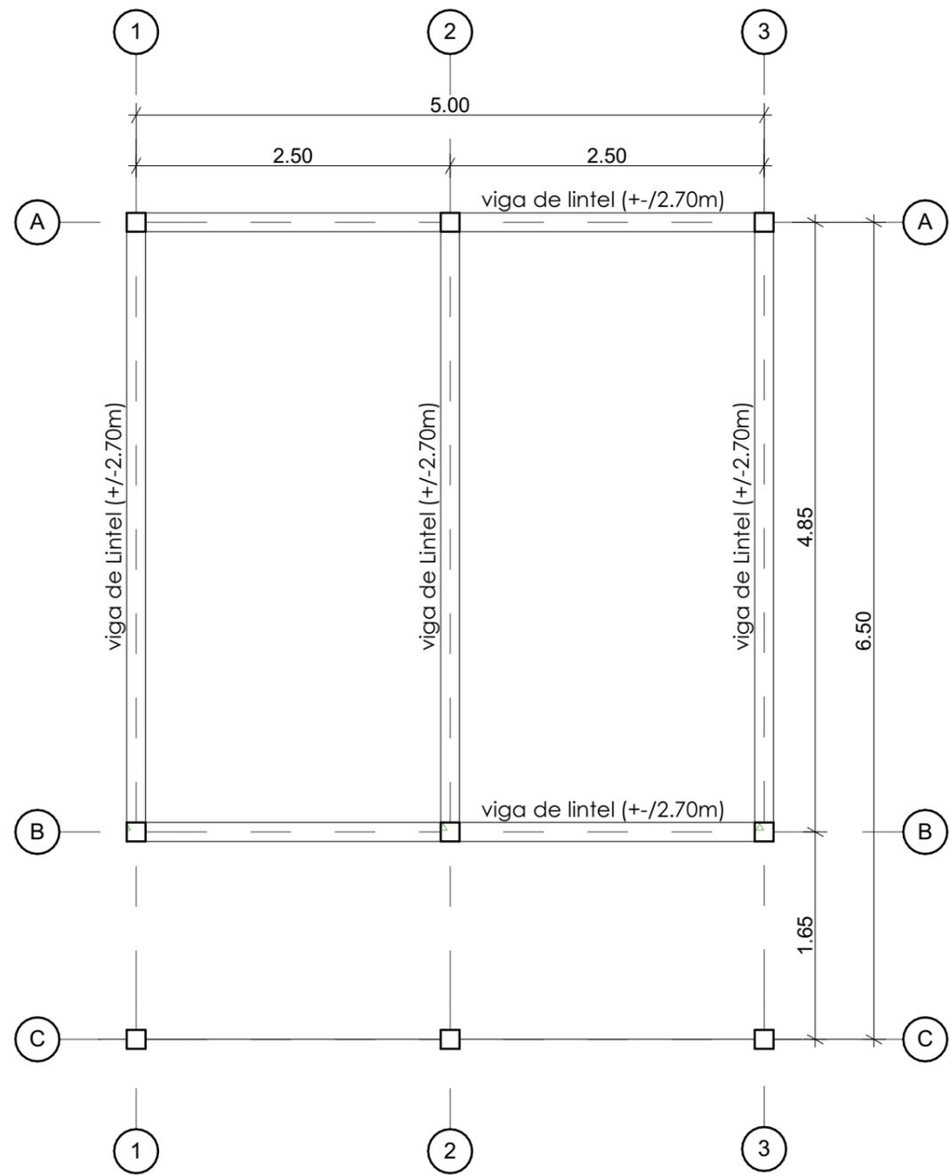
Planta de viga de Lintel
