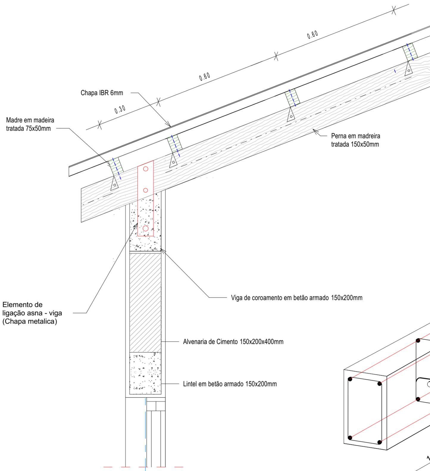
Detalhe 03- Fixação da Chapa metálica na viga
