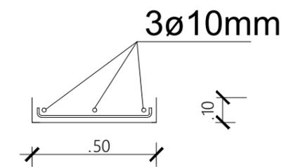
Detalhe de viga de Fundação
