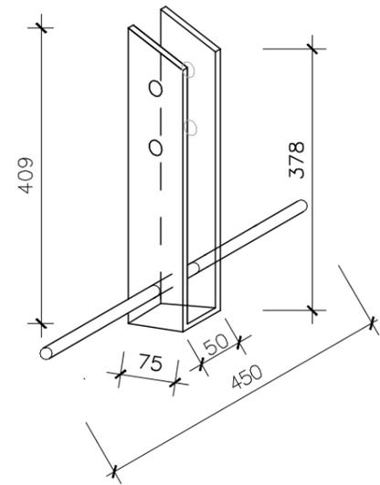
Chapa de Ancoragem para Viga
