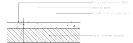
PISO DE GRANITO SOBRE LOSA ESTRUCTURAL
