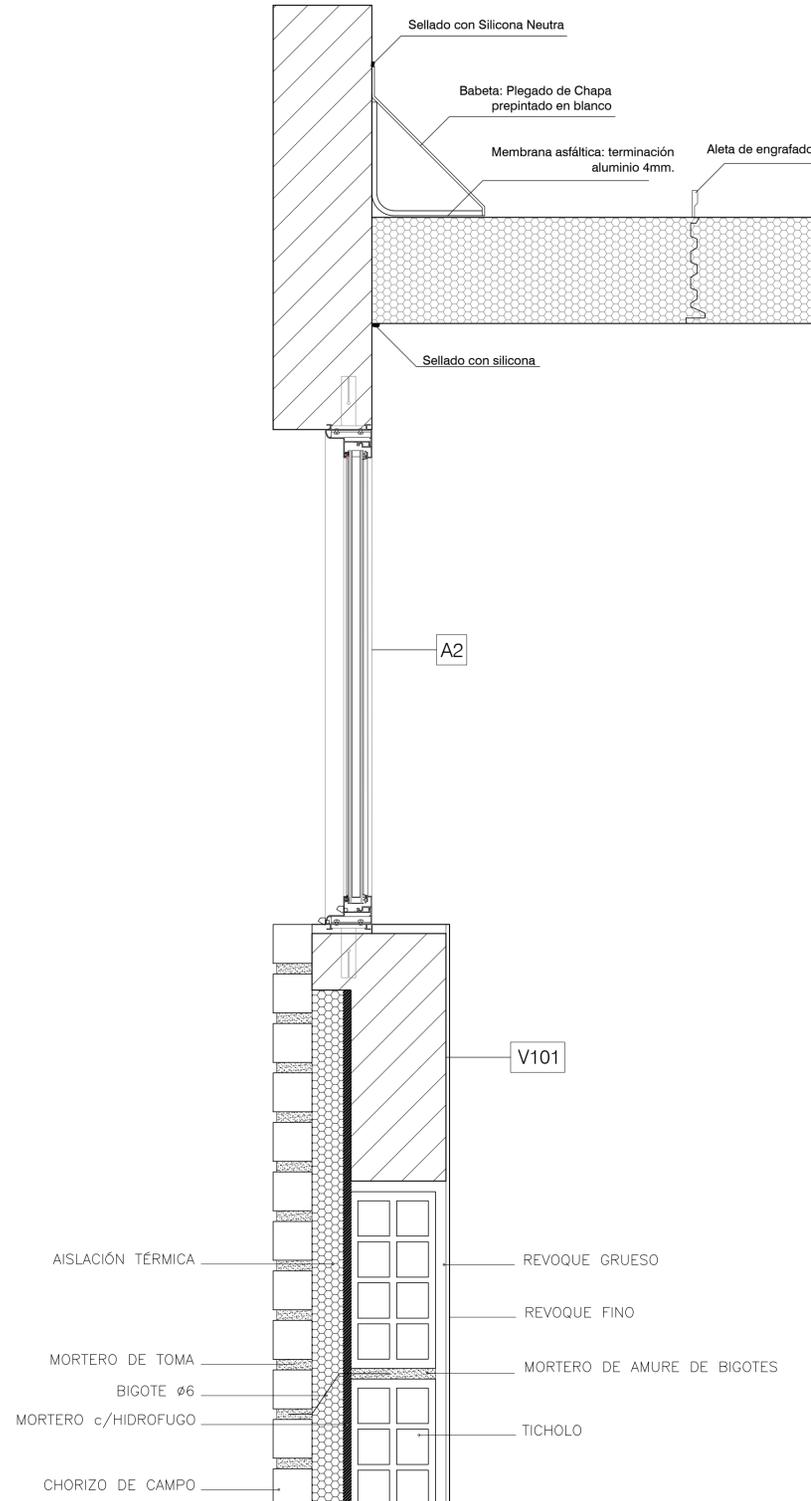
DETALLE 1\_ Panel autoportante con canalón
