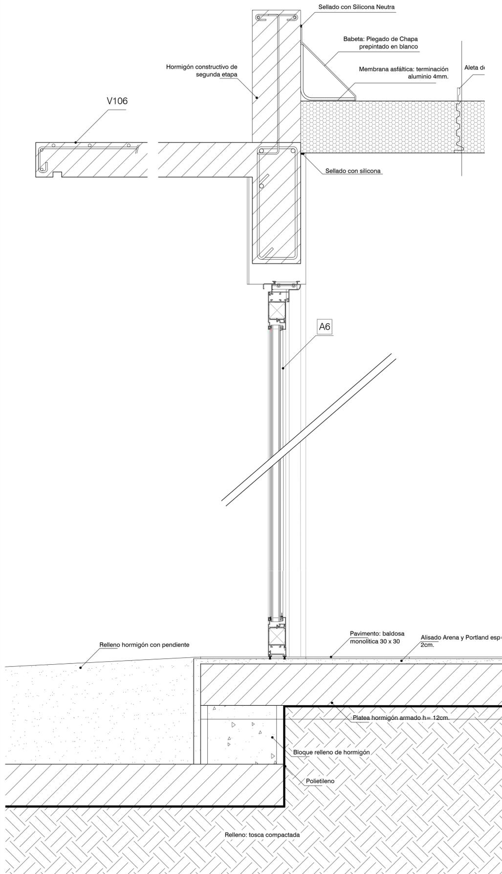
DETALLE 3\_ Encuentro panel autoportante con viga de hormigón
